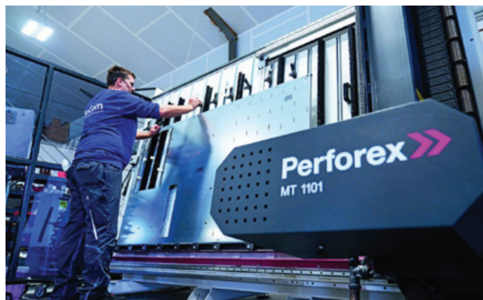
Figura 1. Aceleração: a tecnologia de máquinas automatizadas da Rittal, como o Perforex Milling Terminal MT e a máquina de processamento de fios Wire Terminal WT C totalmente automatizada estão a ajudar a acelerar consideravelmente os processos na AuCom.
