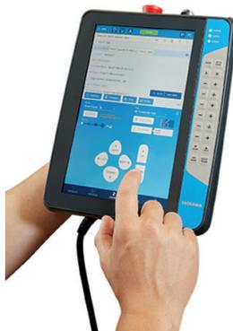
Figura 1. Controlador YRC1000micro com Smart Pendant.
