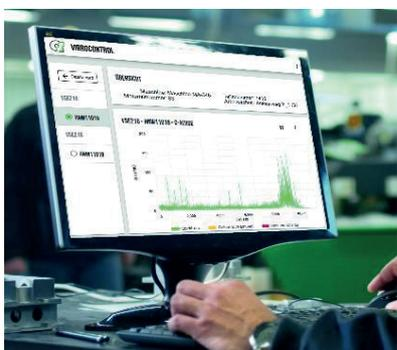
**Figura 2.** O VibroControl é um sistema inovador de deteção precoce para processos de maquinaria. Por exemplo, com esta monitorização do processo, os operadores podem fazer um melhor uso da duração de vida útil das ferramentas, reduzir o desperdício e os períodos de inatividade.
