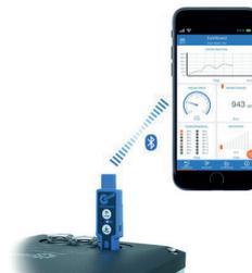
Com a aplicação NORDCON e o *stick* Bluetooth NORDAC ACCESS BT, a NORD criou uma solução móvel de colocação em funcionamento e assistência para todos os acionamentos.
