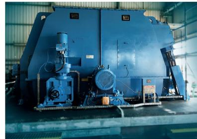
A WEG realizou, para a unidade da REPSOL em Sines, o fornecimento de 1 motor síncrono Exp, 7,2 MW, 6 kV, 30 polos, mais o quadro de excitação, desenvolvendo e implementando uma solução de automatismos de interligação e protecção.
