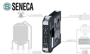
A Seneca amplia a sua gama de conversores de célula de carga, com o Z-SG2. Com isolamento triplo até 1.500 Vac, sensibilidade da célula de carga de 1 a 64 mV/V e classe de precisão de 0,01%, este conversor permite a leitura da medição através do protocolo série ModBUS RTU ou através de saída analógica.
