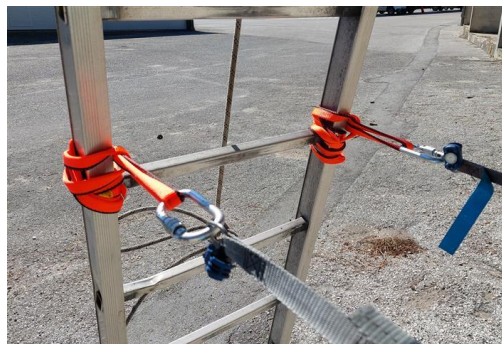
Exemplo ilustrativo da amarração da escada a partir do solo com a utilização de estropos e mosquetões
