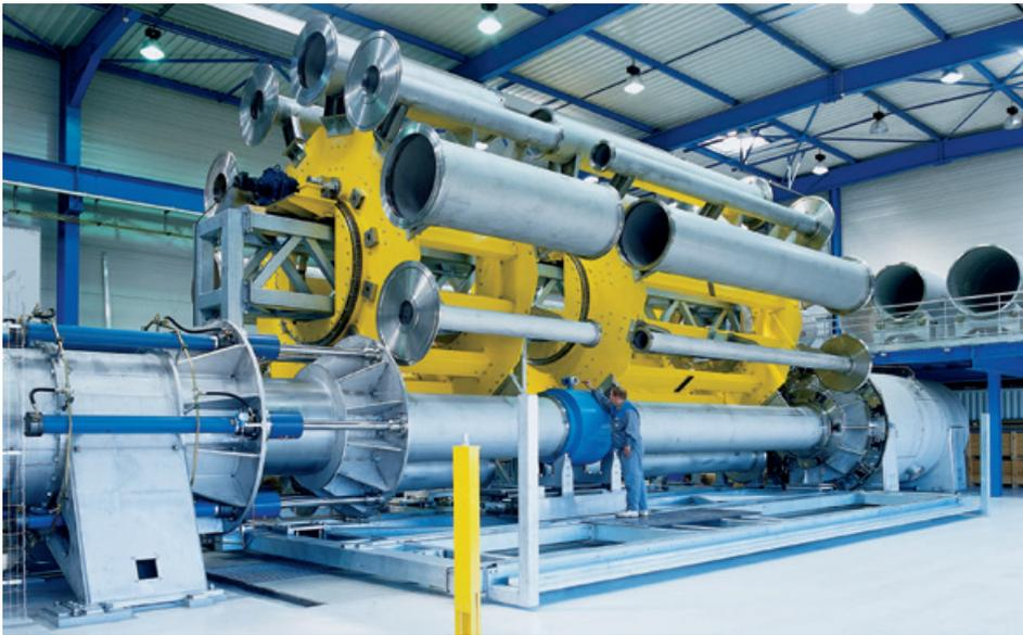
Figura 1. Um equipamento de calibração para diâmetros nominais de até DN 2000 (80"), com um sistema adaptador de revólver, está localizado na Endress+Hauser Flow em Cernay, França.
