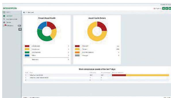
Figura 1. O software ConditionAnalyzer oferece um Condition Monitoring automatizado para rolamentos e elementos de acionamento, baseado nos conhecimentos sobre vibrações e rolamentos da Schaeffler.
