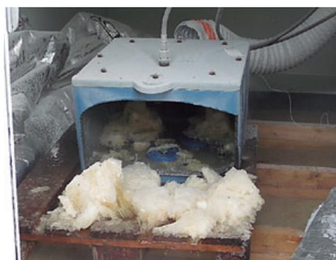
Figura 2. Teste realizado em caixa de terminais em temperatura negativa.
