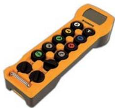
O TGA / TGB é um equipamento móvel muito versátil para aplicações digitais na indústria, bem como para aplicações personalizadas. O *design* ergonómico do transmissor fornece um fácil manuseamento e orientação para o utilizador pelas 12 teclas de função / interruptores rotativos, que podem ser configurados de forma flexível.
