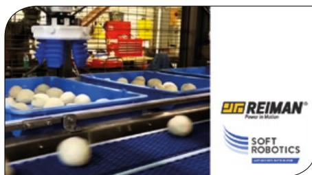
A Soft Robotics foi abordada para estudar a possibilidade de otimizar uma linha de produção de massa para pizza. A aplicação pressupunha a produção de massa fresca e a sua transferência para os tabuleiros de transporte. O desafio consistia no manuseamento da massa, de forma rápida, segura e sanitária, sem perder de vista a otimização do processo de produção.
