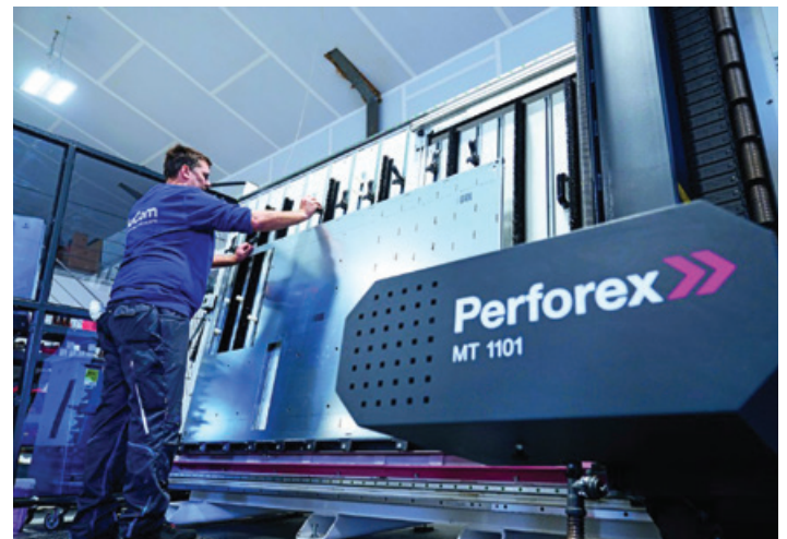
Figura 1. Aceleração: a tecnologia de máquinas automatizadas da Rittal, como o Perforex Milling Terminal MT e a máquina de processamento de fios Wire Terminal WT C totalmente automatizada estão a ajudar a acelerar consideravelmente os processos na AuCom.
