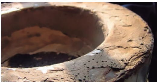
Figura 1. Depósitos devido à presença de Siloxanos.
