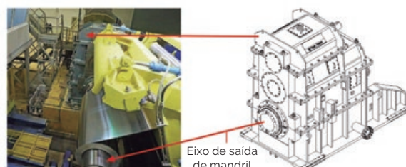
Figura 10. Caixa de engrenagens do bobinador.
