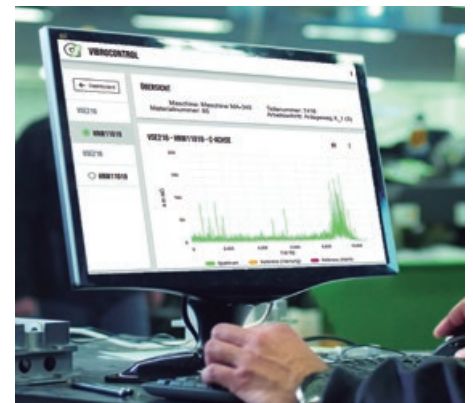
Figura 3. O VibroControl é um sistema inovador de deteção precoce para processos de maquinação. Por exemplo, com esta monitorização do processo, os operadores podem fazer um melhor uso da duração de vida útil das ferramentas, reduzir o desperdício e os períodos de inatividade.
