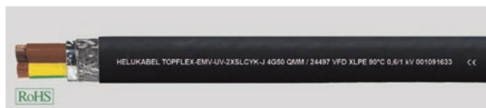
Figura 1. O cabo TOPFLEX EMV-UV-2XSLC11Y é protegido por uma dupla camada de proteção de IEM. A primeira camada, de folha de alumínio especial, envolve os condutores enquanto a segunda camada em trança de cobre estanhado é aplicada antes do cabo ser acabado com uma cobertura exterior em poliuretano (PUR).
