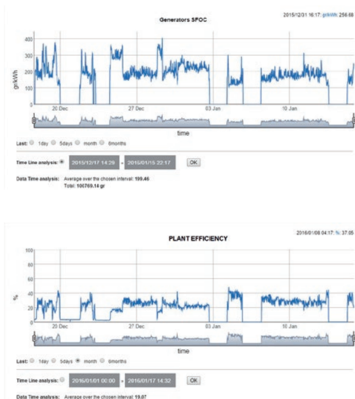
Figuras 2 e 3. Monitorização do consumo específico e rendimento de uma instalação Diesel em função do tempo, através do BOEM-S.
