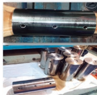
Figura 4. Cavilhão após 3000 h, 24 000 h e 50 000 h.
