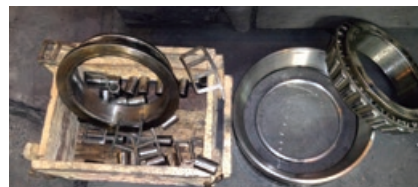
Figura 5. Falhas no rolamento, caixa danificada.
