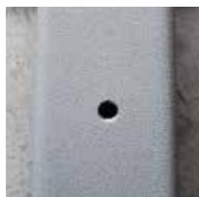
Orifício métrico para fixação chassi superior
