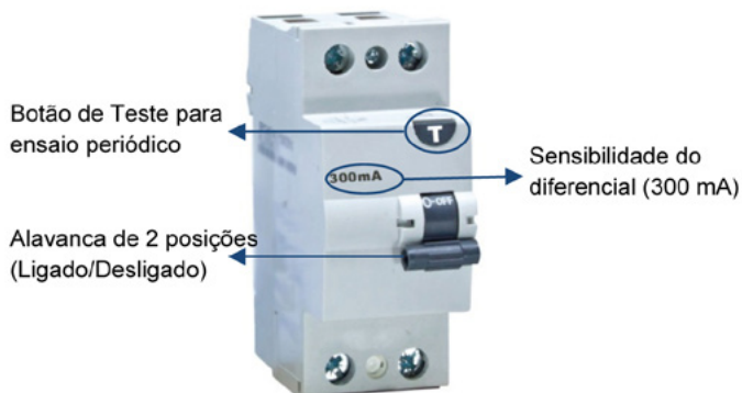
Figura 4. Exemplo de um aparelho de corte sensível à corrente residual diferencial.
