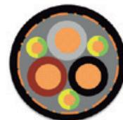
O cabo Afumex Class Varinet VFD 1000 V (AS) foi criado para compensar as induções das fases no condutor de proteção e, por este motivo, está dividido em três condutores de igual secção e simetricamente dispostos relativamente às fases.
