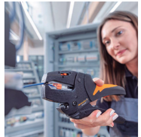
Figura 2. O Stripax® é uma ferramenta de descarte com auto ajuste automático (fonte: Weidmüller).
