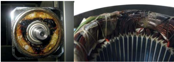
Figura 3. Exemplo de um servomotor danificado por aquecimento excessivo.
