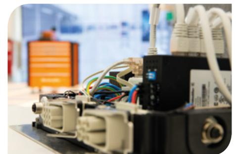
**Figura 4** A máxima resiliência contra as falhas do sistema é fornecida pelo sistema FieldPower® da Weidmüller, através da construção redundante da potência de 24 V e regulador de tensão que atua como uma Smart Factory Grid.
