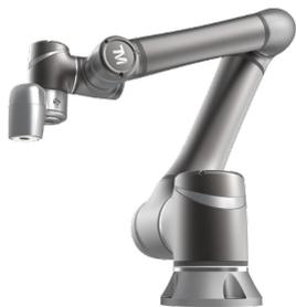
O robot colaborativo TM12 é uma referência na sua classe na capacidade de carga e alcance. Oferece 12 kg de capacidade de carga e 1300 mm de alcance.
