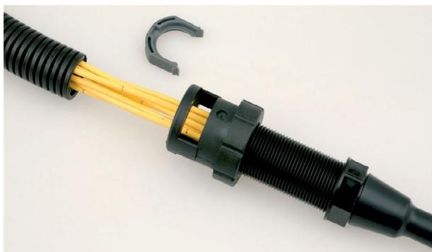
**Figura 4.** Vista detalhada de um distribuidor de fibras impermeável. É montado com um parafuso de junta compatível para instalação nas caixas de fusão da HELUKABEL. Adicionalmente o *kit* pode ser reutilizado.
