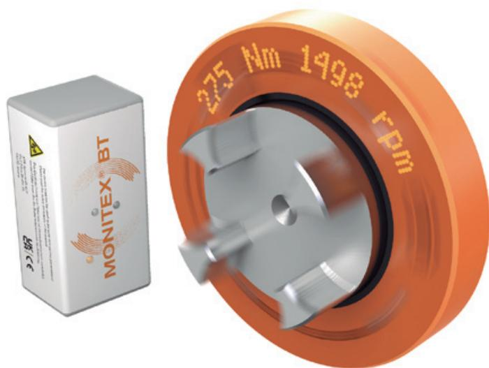
Com a rotação, os dados medidos são exibidos no acoplamento através de um *display* e podem ser enviados via Bluetooth e visualizados num aplicativo relevante. Com o compacto MONITEX BT toda a tecnologia de medição está dentro do cubo de acoplamento que permite integrar o novo acoplamento de medição no *drive* sem grande esforço, mesmo com condições de espaço reduzidas. Os principais campos de aplicação são na monitorização de máquinas, tecnologia
