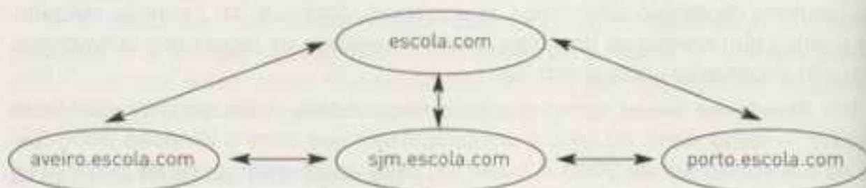
**Fig. 3.3** Esquema de implementação de uma árvore composta por quatro domínios. Neste exemplo existe um domínio de topo, que interliga todos os domínios; pode ser possível partilhar recursos entre os utilizadores dos quatro domínios.
