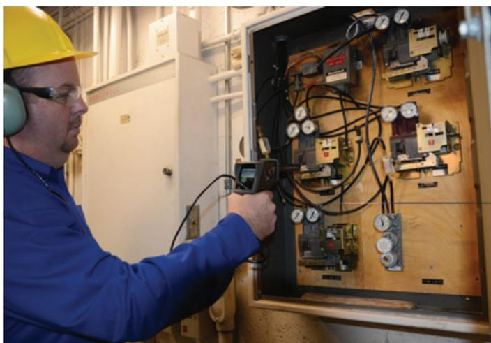
Um dos principais fatores que contribuem para o desperdício de energia são as fugas: tanto nos sistemas de ar comprimido como nos purgadores de vapor. Os instrumentos de inspeção por ultrassons podem detetar facilmente estas fugas, conduzindo a potenciais poupanças de energia.
