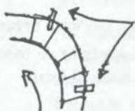
DESAPARAFUSAR E TIRAR OS PARAFUSOS DA LINHA EXTERIOR, NAS CURVAS.
