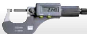
**MICRÓMETRO DE EXTERIORES ELECTRÓNICO DIGITAL**
