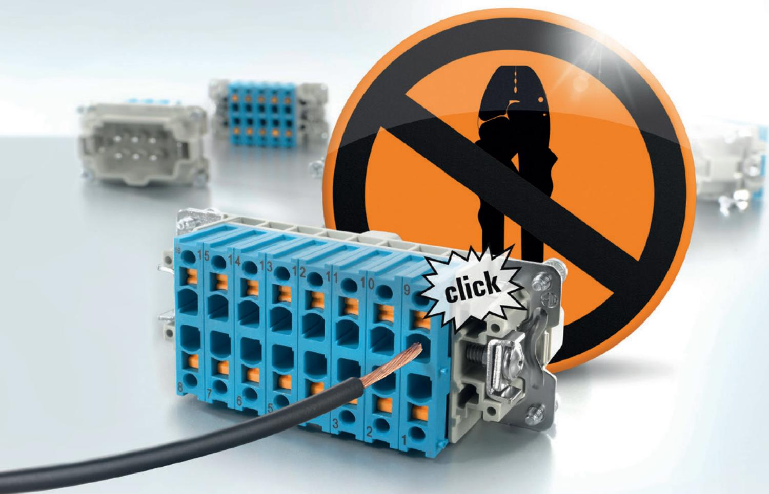
O sistema de ligação QT permite uma significativa aceleração dos processos de instalação e manutenção. Fios flexíveis e descarnados de 0,5 a 2,5 mm<sup>2</sup> (AWG 20 a 16) são facilmente inseridos no ponto de ligação aberto. Basta um *click*. Tudo isto é feito sem ferramentas.
