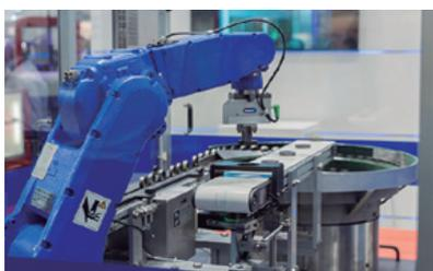
A SCHUNK, uma referência mundial em técnicas de fixação e sistemas de fixação, apresenta a pinça elétrica WSG numa aplicação para manipular anéis metálicos com uma elevada precisão. Este novo sistema garante um controlo exato do processo.
