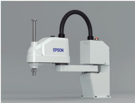
O novo *robot* T6 consegue transportar objetos maiores e mais pesados, com uma capacidade de carga de 6 kg – o dobro da do *robot* T3. O T6 pode ser equipado com manipuladores terminais pesados, como manipuladores terminais duplos para agarrar dois objetos em simultâneo, para ajudar os fabricantes a aumentarem a produtividade das fábricas.
