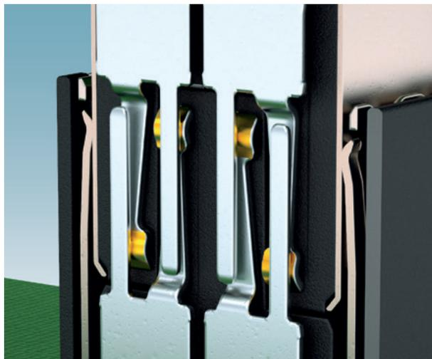
**Figura 4.** Sistema de contacto ScaleX: os contactos de dupla face permitem uma elevada estabilidade e suportam até 500 ciclos de ligação.
