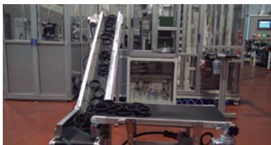
A Robótica Guiada por Visão (VGR) é uma necessidade existente na indústria que permite o uso de *robots* em ambientes flexíveis e em mudança. Uma parte importante das soluções VGR é o 3D Picking que consiste na extração de peças empilhadas aleatoriamente num espaço (*container*, *fitas* ...) usando um sistema de visão 3D para a localização e um sistema robótico para a extração e para a sua posterior realocação.
