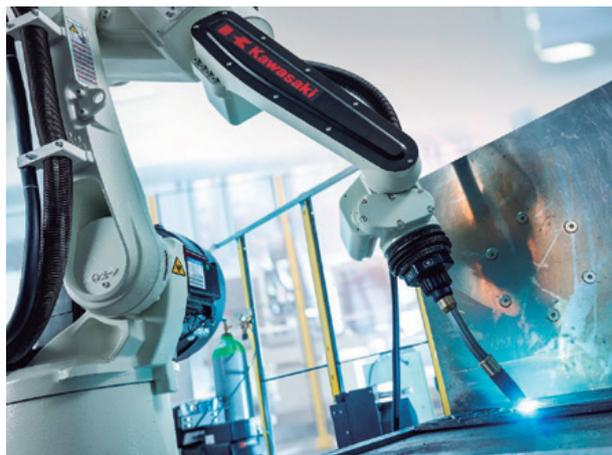
Figura 1. Robot de soldadura BA006 L da Kawasaki Robotics.
