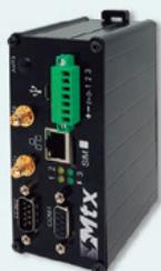
O MTX-GTW II é um equipamento com conectividade 3G ou 4G, dispõe de 1 processador embebido Cortex-A7 e sistema operativo Linux e Java.
