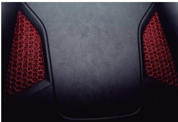
**Figura 4.** Protótipo de *Baquet* com enchimento impresso em 3D: aspecto da capa exterior, 2020, Porsche AG. Imagem fonte: [14].
