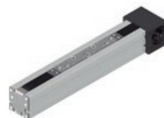
O corpo do eixo linear LLZ 40 é constituído por um perfil de alumínio de secção quadrada, com guiamentos integrados internamente. A carruagem é movida por meio de uma correia dentada rotativa interna. Na área de automação industrial, tempos de ciclo elevados e dinâmica desempenham um papel essencial para os fabricantes de máquinas.
