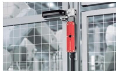
Existem máquinas, que mesmo depois de desligadas, continuam com determinadas áreas ativas. Em que o operador da máquina está impedido de aceder a estas áreas até que o movimento perigoso fique completamente parado. Por exemplo, na descida lenta das lâminas de uma serra ou na paragem de uma
