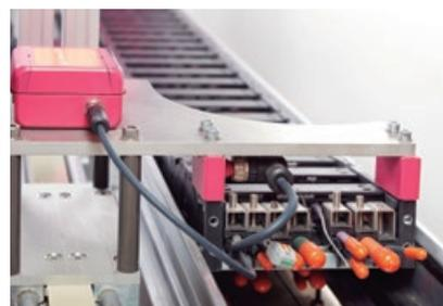
**Figuras 2 e 3.** Os sensores das calhas articuladas, como o EC.M, recolhem valores relativos à aceleração, velocidade, temperatura e ciclos, fornecendo, assim, dados para o cálculo do tempo mínimo em funcionamento ininterrupto (Fonte: igus GmbH).
