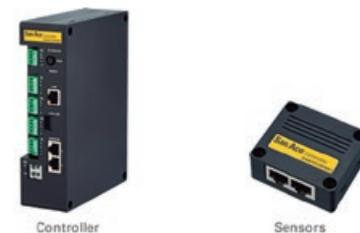
A Sanyo Denki desenvolveu o primeiro Controlador San Ace, que permite um controlo automático de velocidade e monitorização remota de ventiladores PWM
