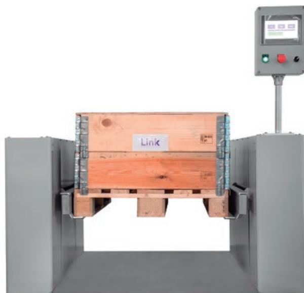
Figura 1. Estação elevatória de paletes.
