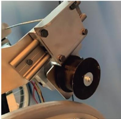
A utilização de uniões neste projeto permitiu que as embraiagens servissem como transmissão de binário do eixo da engrenagem para a roda de fricção, permitindo que a velocidade do motor fosse alterada com facilidade.
