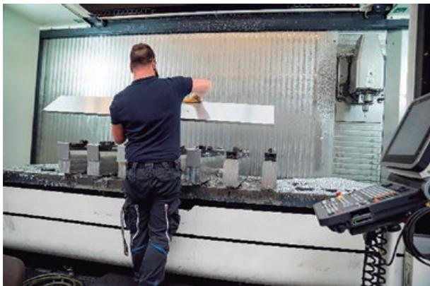
**Figura 1.** Placas de arrefecimento de até 3,20 m de comprimento, com canais de refrigeração para o sistema elétrico dos armários das máquinas de embalagem do Grupo Schubert são um exemplo típico dos muitos trabalhos recorrentes da empresa.
