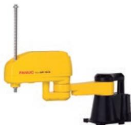
A FANUC apresentou o terceiro modelo da sua linha de robots SCARA, o SR-12iA. Este robot dispõe de uma capacidade de carga de 12 kg, uma inércia do punho de 0.30 kgm<sup>2</sup> e ocupa uma área reduzida, o que abre novas possibilidades ao nível do *pick&place*, montagem e manipulação de material, teste/inspeção e embalagem numa vasta gama de indústrias. Este modelo também estará disponível em versão *water proof*.
