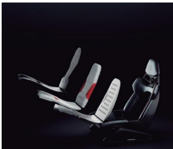
**Figura 3.** Protótipo de Baquet com enchimento impresso em 3D: estrutura modular com camadas individuais, 2020, Porsche AG. Imagem fonte: [14].
