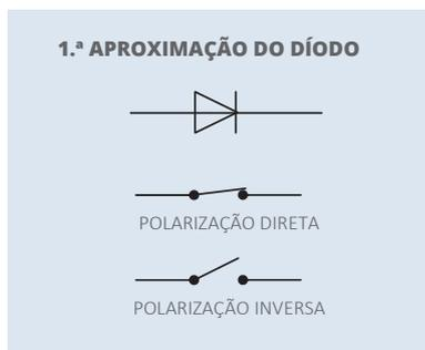
Figura 91. 1.ª aproximação do diodo (diodo ideal).
