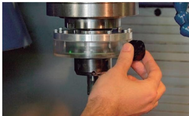
Figura 1. Sistema On/Off Magnético.
