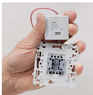
**01** Depois de ligado o emissor ao mecanismo (interruptor ou botão de pressão), iniciar a configuração pressionando a tecla **cfg** e de seguida a tecla do mecanismo.
