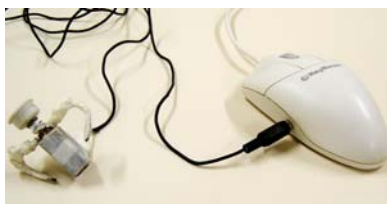
Figura 14 – Acionador confeccionado com botão liga/desliga de computador
