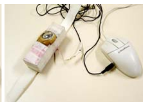
Figura 15 – Switches para acionamento com a cabeça, feito com botão grande de sucata
