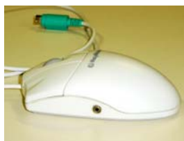
Figura 13 – Mouse adaptado com plug
