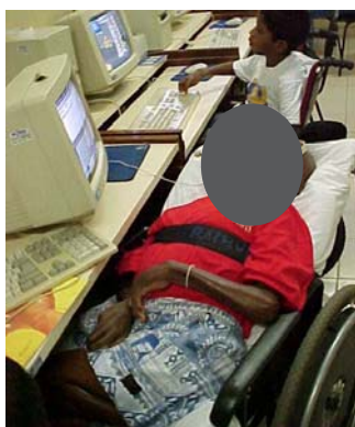
Figura 10 - Comandando o computador com sopros no microfone
