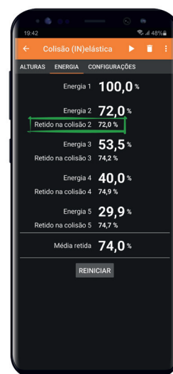
Figura 7 - Percentagem de energia mecânica que permaneceu na bola em cada colisão.
