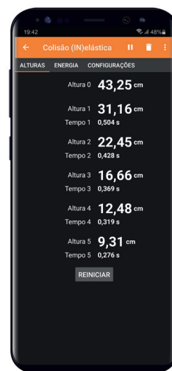
Figura 6 - Resultados obtidos com uma bola de desodorizante e uma superfície de madeira.
