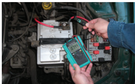
Figura 4. Medição da corrente DC de uma bateria de 12 V de automóvel.
