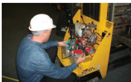
Figura 5. Na manutenção de um empilhador, podemos medir a corrente DC da sua bateria.
