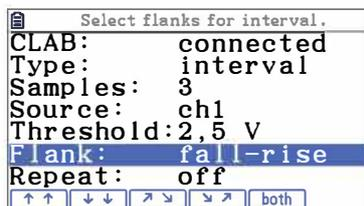
A opção *Flank* permite seleccionar o flanco onde inicia e termina a medição do intervalo de tempo. A figura 2 mostra as opções disponíveis.
