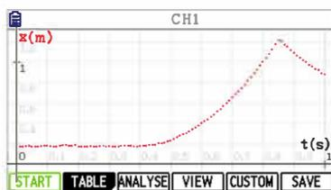
Solicitar uma regressão quadrática para a queda da bola. Pressionar **F3** (ANALYSE), **F6** (FIT) e **F3** (QUAD).
