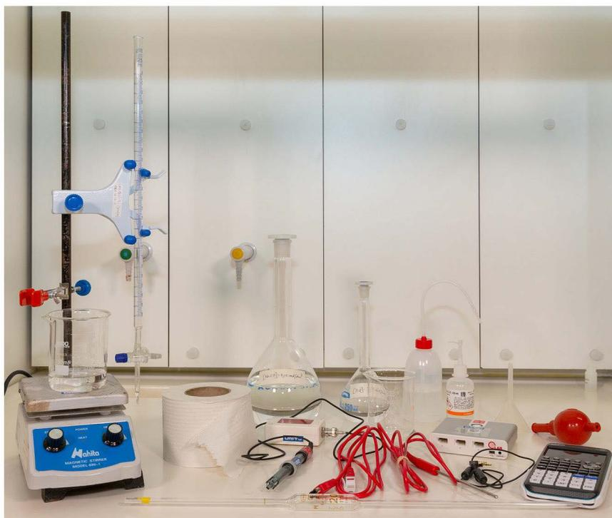
Figura 1 – Material necessário para a titulação potenciométrica.
