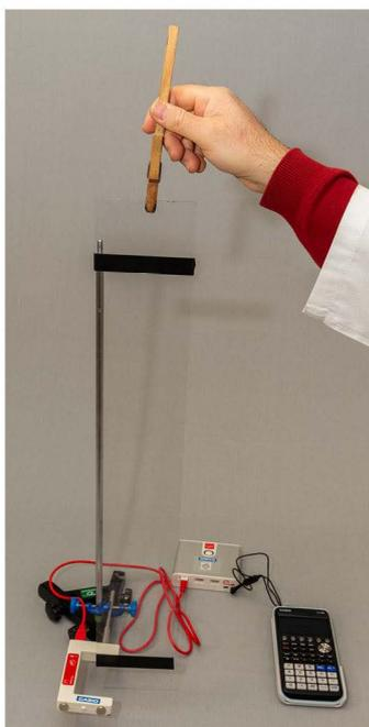
Figura 7 – Posição de largada da placa de acrílico.
