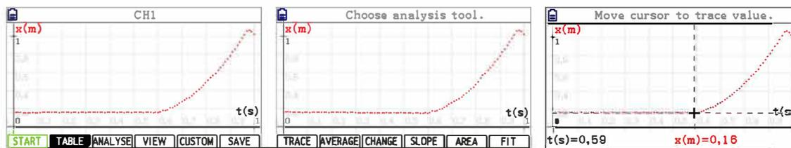
De seguida, criar o gráfico da velocidade em função da posição. Assim, pressionar **[F5]** (CUSTOM).
