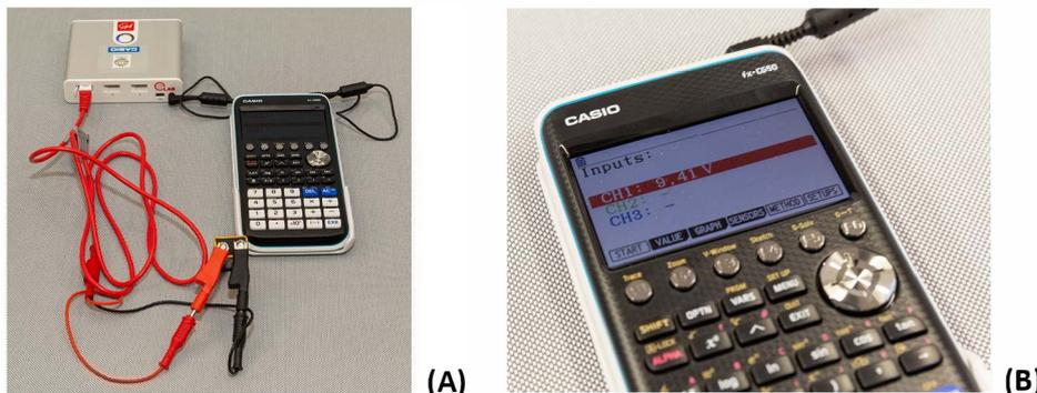
**Figura 1** – (A) Material e montagem para medir a força eletromotriz da pilha, (B) Valor da força eletromotriz da pilha apresentado no ecrã da calculadora.
