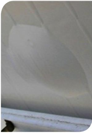
**Figura 4** Bolhas na parte traseira do módulo (Fonte: IEA).
