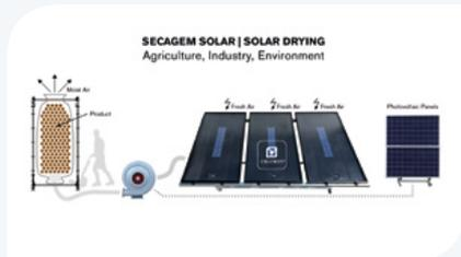
Desafiada por muitos clientes e por potenciais interessados na aplicação da secagem solar de produtos em *big-bags*, a Chatron desenvolveu um *kit* totalmente autónomo e sem qualquer consumo energético da
