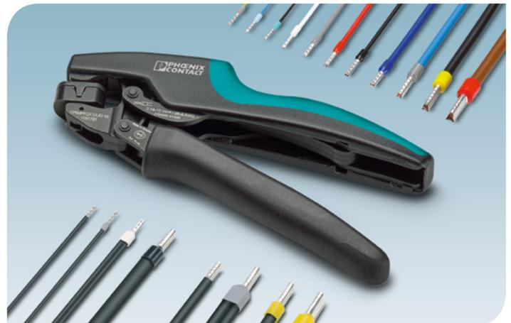
**Figura 4** Performance: o CRIMPFOX DUO 10 crava ponteiras simples de acordo com a DIN 46228-1/-4 de 0,14 mm<sup>2</sup> a 10 mm<sup>2</sup> e ponteiras duplas conforme UL 486F de 2 x 0,5 mm<sup>2</sup> a 2 x 4 mm<sup>2</sup>.
