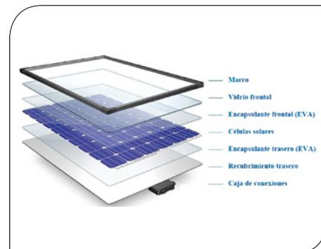
**Figura 3** Estrutura do módulo solar de silício (Fonte: <http://blogs.publico.es/lignacio-martil/2017/06/23/como-lograr-energia-limpia-y-abundante-de-la-celula-solar-al-sistema-fotovoltaico/>).
