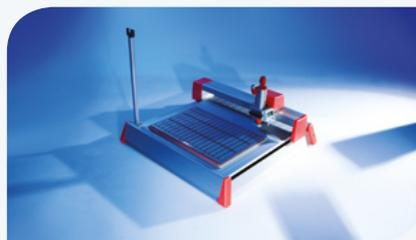
DMG), mas também em alumínio (ALU/ALM). O sistema de gravação MGS 50 utiliza um conceito baseado em *plotter* com uma cabeça de gravação que pode utilizar fresas de várias medidas, utilizadas para obter aca-
