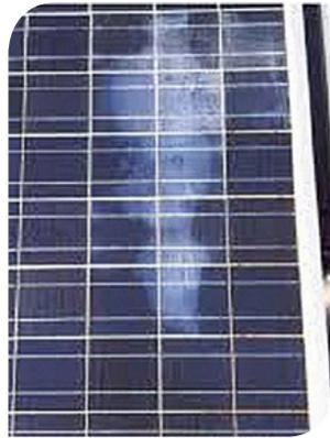
**Figura 5** Delaminação visível como zona leitosa na parte frontal (Fonte: Researchgate).
