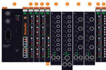
Figura 4. Servidor web HTML5 integrado no sistema de periferia U-Remote da Weidmüller.
