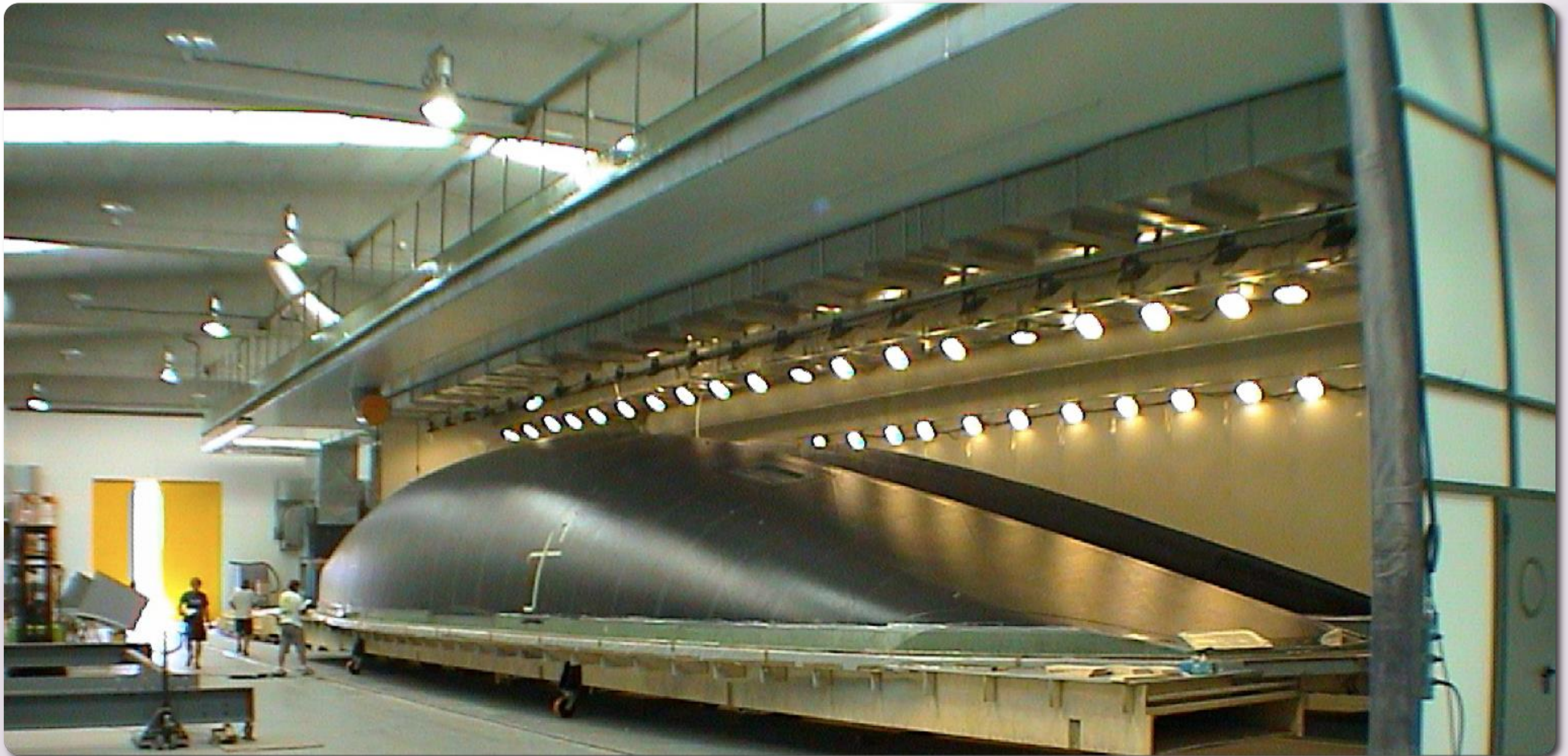
Fornos de polimerização para Pre-impregnados
