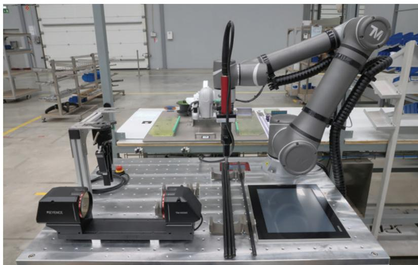
Figura 1. Braço robótico, ferramentas e sensores 2D e 3D montados no topo da plataforma móvel.
