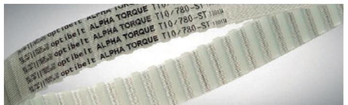
A optibelt ALPHA TORQUE é equipada com poliuretano resistente à abrasividade, com uma dureza de 86 Shore A. A boa resistência a óleos para o poliuretano faz também parte das suas características fundamentais, tal como uma determinada resistência a ácidos e a soluções alcalinas.
