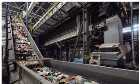
Os tapetes com perfis destinados ao transporte inclinado de materiais não permitem a instalação de raspadores convencionais. A dificuldade que pressupõe conseguir um nível de limpeza adequado com este tipo de tapetes levou ao desenvolvimento de diversas soluções, cada uma delas com limitações de vária índole.
