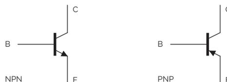
Figura 170. Simbologia dos transistores NPN (à esquerda) e PNP (à direita).
