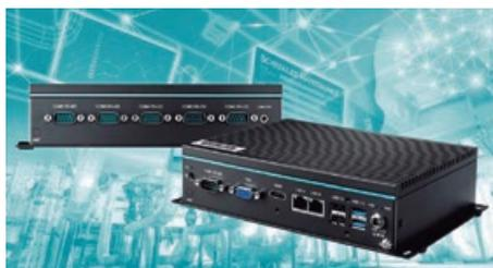
Por vezes existem aplicações que não exigem grande *performance* ao nível do CPU, mas em que a versatilidade do computador acaba por ser um fator decisivo. O computador industrial UNO-247 da Advantech integra várias *interfaces* onde se destacam as 2xLAN,
