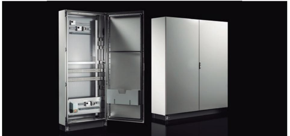
de capacidade de carga de 1,5 toneladas. Para ambientes ainda mais exigentes, o armário VX SE está disponível opcionalmente com proteção IP 66 e NEMA 4/4x. Placas de passagem de cabos integradas na base simplificam a cablagem, mesmo em armários com componentes extremamente densos, e garantem que as tarefas preparatórias para a cablagem possam ser realizadas ergonomicamente.
