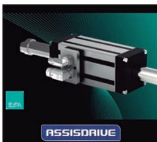
O Atuador linear elétrico "Green Drive Standard" é o novo produto da ESA e consiste num motor de acionamento direto de ímãs permanentes com *design* quadrado similar aos típicos cilindros pneumáticos. As dimensões foram estudadas para serem compatíveis com as dimensões *standards* dos cilindros pneumáticos evitando, desta forma, os custos de adaptação mecânica e reduzindo o tempo de substituição.
