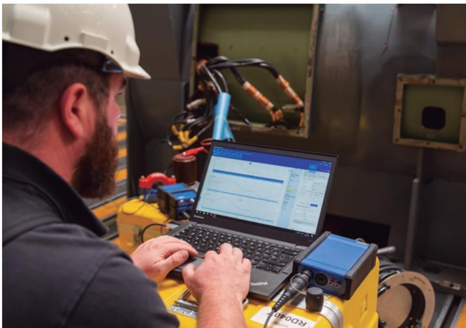
Figura 2. Teste de descarga parcial num gerador com sistema MPD 800 da OMICRON.
