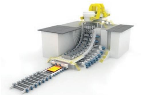
Figura 1. Layout típico de lingotamento de laje.
