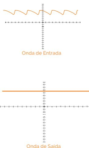
Figura 148. Tensão de entrada e tensão de saída num circuito estabilizador com diodo de Zener.
