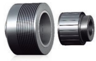
A KTR desenvolveu um acoplamento que transmite o torque sem contacto por meio de forças magnéticas, limitando o torque livre de desgaste em caso de sobrecarga; além disso, o acoplamento pode ser aplicado como travão. O acoplamento de histerese MINEX®-H está atualmente disponível em 3 tamanhos para torques de sobrecarga de 1,2 a 6 Nm.
