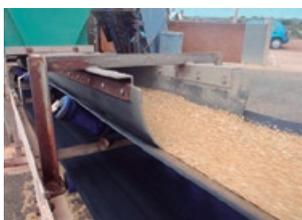
As bavetes são peças de borracha, com *design* especial, colocadas lateralmente nos transportadores, para evitar que os materiais saiam da linha de movimentação e permaneçam no tapete. O seu uso nos transportadores evita o desgaste prematuro do tapete e contribui para uma vida útil mais longa.
