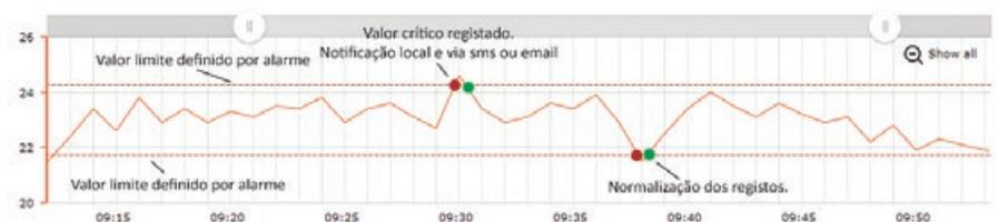
Figura 2. Valores limite e ações de notificação.
