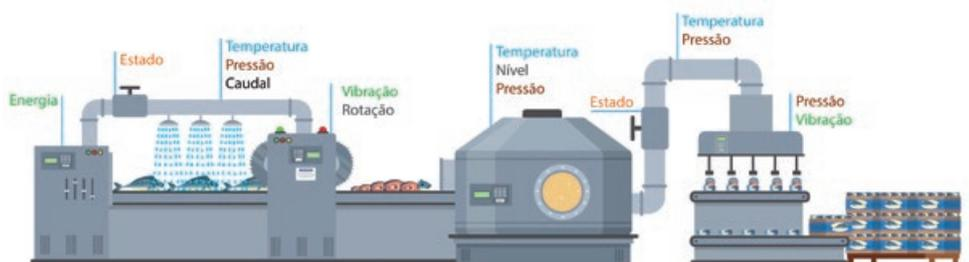
Figura 1. Variáveis existentes nos equipamentos de produção.
