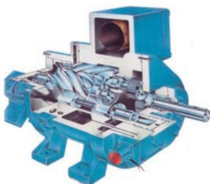
Figura 4. Compressor de parafuso.
