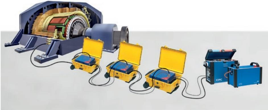
Figura 1. A solução de teste de 15 kV da OMICRON para máquinas rotativas inclui o amplificador de tensão CP TD15 e o módulo de medição de dissipação / fator de potência, o reator de compensação CP CR600 e o testador multifuncional CPC 100.
