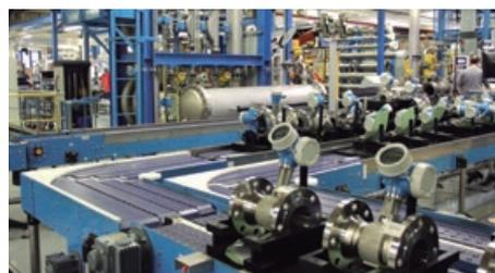
Com as suas inovações em tecnologia de medição de fluxo de vortex e Coriolis, a Endress+Hauser tem realizado os desejos dos seus clientes por quase 4 décadas. A empresa já ultrapassou 2 marcos notáveis: a produção de mais de 1 milhão de medidores de fluxo Coriolis e 500 000 medidores de vortex.
