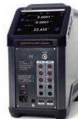
O ADT875-155 é o novo calibrador de bloco seco da Additel. Com este equipamento a Additel entra em grande na calibração da temperatura, que combina uma excelente estabilidade, uniformidade radial e axial, com rapidez. Através da opção PC acrescentamos a capacidade de leitura de 3 canais de temperatura com um calibrador de processo.
