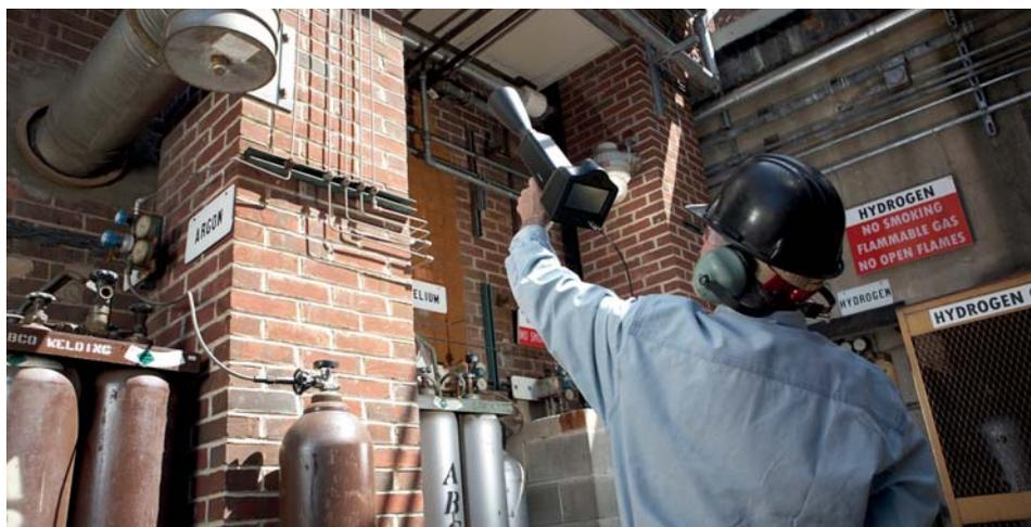
se afasta da fonte. Além disso, as ondas ultrassónicas propagam-se pelo ar como ondas longitudinais, ou seja, propagam-se numa direção fixa. Como os sensores ultrassónicos não detetam componentes de baixa frequência, podem ser muito eficazes a localizar e identificar uma fuga, mesmo em ambientes industriais muito ruidosos, pois não são afetados por estes.
