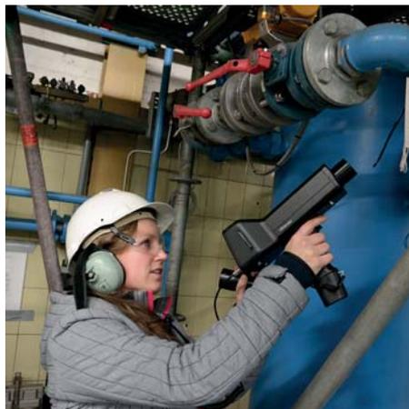
realizar inspeções em sistemas isolados, será necessário remover o isolamento antes da inspeção. Para fugas de volume interno, pode tentar executar uma inspeção com um módulo de contato para determinar a área onde o som é percebido com a maior amplitude acústica, que será a área mais próxima da fonte da fuga. Ao inspecionar fugas num espaço confinado, siga todos os procedimentos de segurança necessários. A concentração de gases pode ser alta e qualquer erro pode ser fatal.
