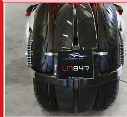
Dois pneus traseiros Michelin Power Cup Evo transmitem 470 cv de potência ao asfalto.
