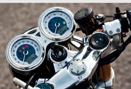
Belíssima e muito completa a instrumentação. Ajustes da forquilha no topo da mesma.
