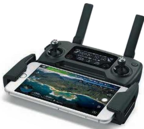
■ O comando tem duas "garras" para fixar o smartphone. À primeira vista, ficámos com dúvidas quanto à segurança deste sistema, mas depois de usar percebemos que é muito difícil fazer o smartphone cair. São fornecidos cabos Micro USB e Lightning, o que garante a compatibilidade com a maioria dos smartphones (é possível usar outros cabos).
