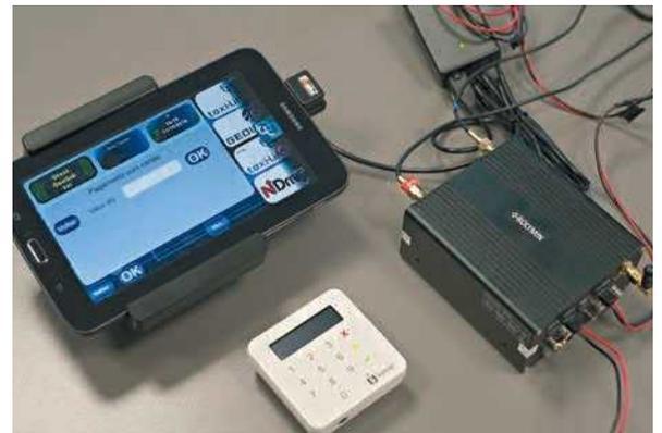
**A Geolink desenvolveu uma caixa negra que permite a localização e o lançamento de alertas, e disponibiliza Wi-Fi e pagamentos por Multibanco**
