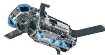
■ Em minutos o Mavic Pro está pronto a voar. Nem é preciso montar/desmontar hélices (elas vão ao sítio mal os motores arrancam). No total, há cinco câmaras e dois sensores ultrassónicos para que o drone detete obstáculos à frente e por baixo. Aliás, o Mavic é capaz de acompanhar automaticamente o motivo ajustando-se ao terreno. Mas continua a não haver deteção de obstáculos quando se voa para os lados ou para trás.
