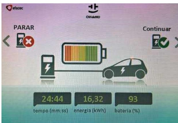
Os Postos de Carga Rápida (PCR) instalados na A1 e A2 permitem carregar boa parte da bateria entre 15 a 30 minutos. A carga torna-se mais lenta na parte final, razão pela qual não vale a pena ultrapassar os 80 a 90 % de carga
