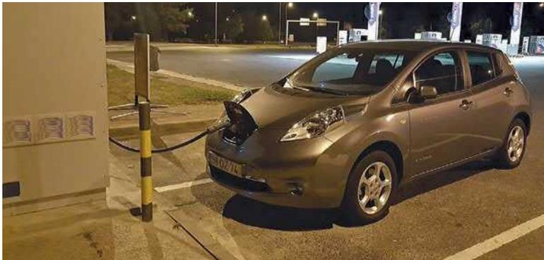
Carregamento rápido em Alcácer, já no regresso do Algarve para Paço de Arcos. O tempo de carga aumentou devido ao aumento da temperatura das baterias
