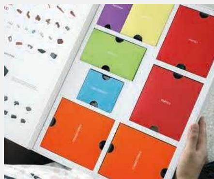
■ As diferentes peças e acessórios que constituem o kit vêm bem arrumadas em caixas independentes, o que diminui o tempo de procura da "peça certa". No total, são fornecidas 372 blocos ou peças de montagem, sete motores e quatro cabos de ligação à unidade de controlo.
