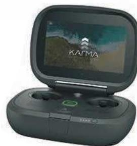
■ O comando liga-se por Wi-Fi à Internet. Esta ligação não é necessária para operar o drone, mas permite descarregar antecipadamente os mapas das áreas onde vamos voar. O que é fundamental para criar rotas de voo automatizado. O comando inclui a função Passenger App que permite que outro utilizador controle a câmara através de um smartphone.
