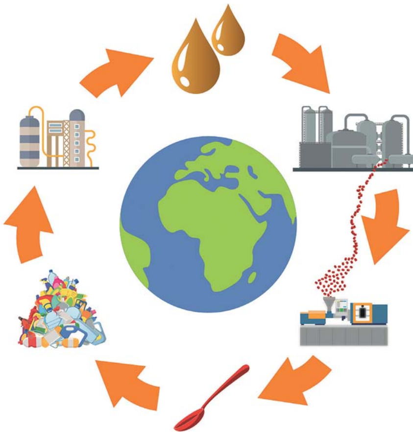
Figura 2. O novo ciclo de vida dos plásticos: com a tecnologia de Reator Hidrotérmico Catalítico, os resíduos de plástico podem ser convertidos em óleo, permitindo a criação de novos produtos em polímero. (Fonte: igus GmbH)
