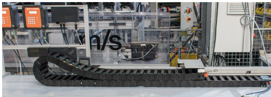
Figura 4. Produtos inteligentes da igus: sensor de força na extremidade móvel flutuante para controlar a calha articulada durante o funcionamento. Se um corpo estranho bloquear a calha articulada, a força de deslocação irá aumentar. A partir de um valor limite definido, o sensor envia um sinal que é registado por um módulo de avaliação e é transmitido ao módulo de comunicação icom. Se forem excedidas as forças admissíveis, o sistema para o equipamento antes que possa provocar danos de maior dimensão (Fonte: igus GmbH).
