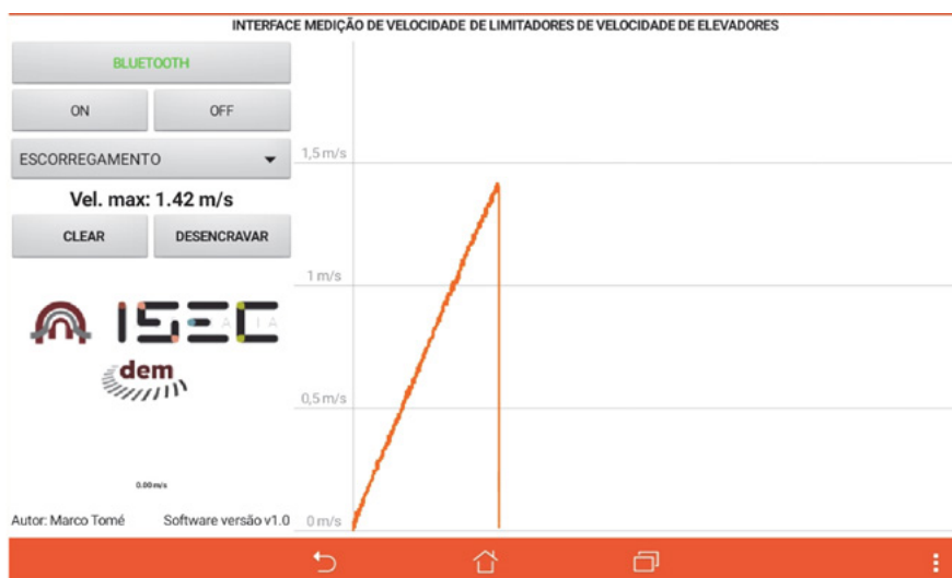
Figura 8. Exemplo de relatório final obtido após ensaio de escorregamento.
