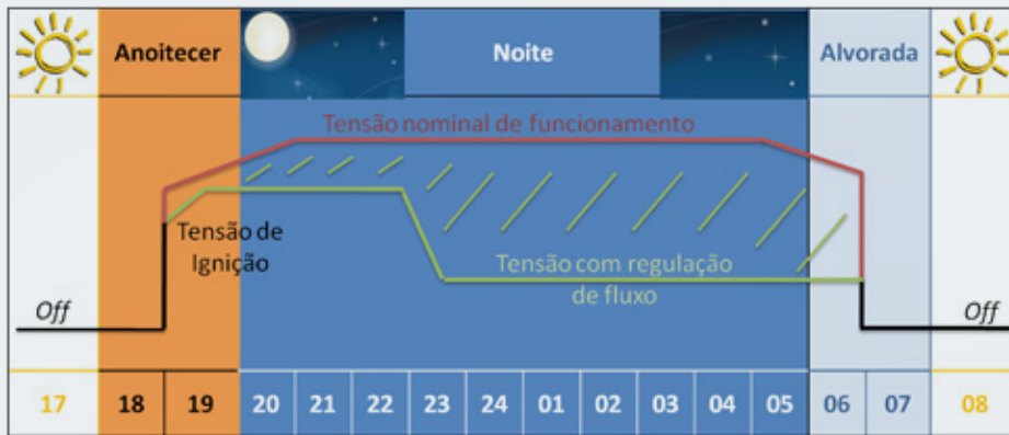
Figura 5.14 - Exemplo de funcionamento de um Regulador de Fluxo ao longo do período noturno
