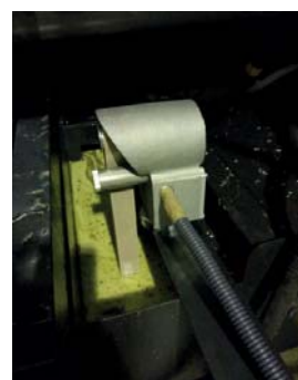
Figura 3. Skimmer em funcionamento no tanque de armazenamento das emulsões no centro de maquinação CNC – Núcleo de Amarante do CENFIM.
