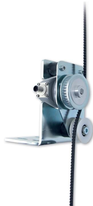
A utilização do sistema SILENT MOVE do fabricante Wachendorff revela detalhes técnicos como velocidades até 4 m/s e alturas até 120 m, o sistema inclui todas as peças mecânicas para montagem no eixo, paragem suave com um movimento de elevação aprimorado, vida útil longa, resistente à contaminação do eixo e não necessita de manutenção, por exemplo, não é necessário aplicar nenhum pó na correia.
