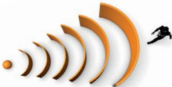
Os sensores de alta tecnologia emitem sinais com uma frequência de 5,8 GHz (1/1000 da frequência de um telemóvel) que até conseguem atravessar na perfeição paredes e superfícies de vidro ou material de construção leve. Os sinais são devolvidos ao sensor pelo ambiente, em forma de eco. Se um movimento dentro da área de deteção modificar a imagem refletida pelo eco, o sensor reage e acende a luz em frações de segundo.
