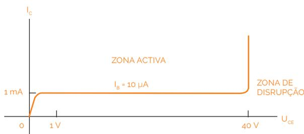
Figura 175. Curva caraterística de saída ( $I_C$ ;  $U_{CE}$ ) - transistor 2N3904.
