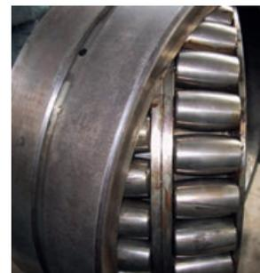
Figura 3. Rolamento autocompensador de rolos antes da remanufatura do rolamento. ©The Timken Company
