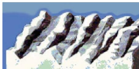
O atrito e o desgaste ocorrem sempre que duas superfícies com movimento relativo se deslocam uma sobre a outra, visto que a área de contacto entre elas é relativamente diminuta dado que resulta do somatório das áreas dos "picos das montanhas". Logicamente as pressões geradas são muito elevadas.
