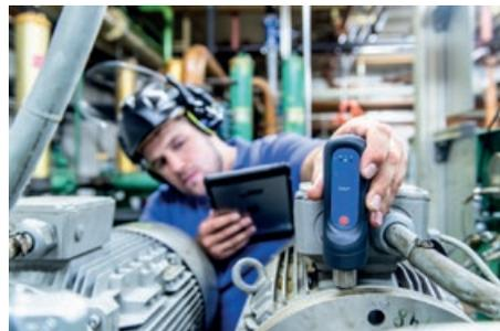
A solução SKF Enlight ProCollect, funciona em dispositivos iOS e Android, e foi projetada para uma utilização simples por qualquer pessoa, independentemente do seu conhecimento, para monitorizar os ativos de produção da sua fábrica. É uma solução de monitorização de vibração digital que permite facilmente a implementação de práticas de manutenção eficazes com base na condição, no âmbito de soluções da Indústria 4.0.
