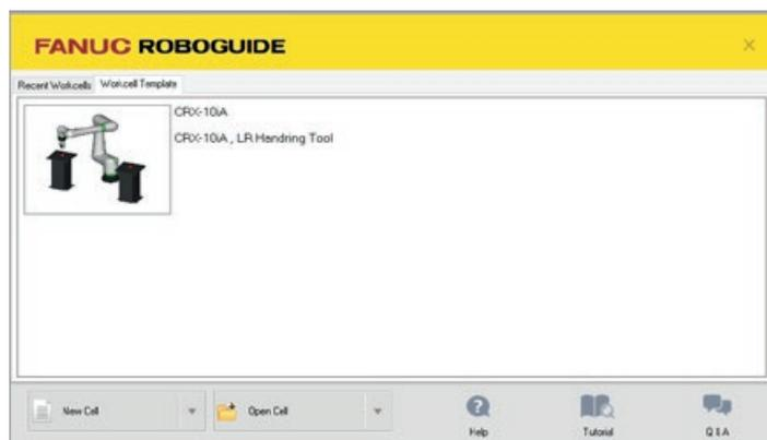
A designação de um novo projeto no *software* Roboguide é designada por uma nova célula de trabalho, *New Workcell*.
