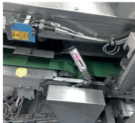
Figura 5. Lubrificação de rolamento no rolo de transmissão de um tapete transportador na produção de batatas fritas.
