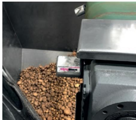
Figura 2. Duas unidades simalube 60 ml lubrificam os rolamentos do rolo defletor de um tapete transportador no processamento de batata.
