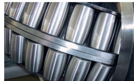
Figura 4. Rolamento autocompensador de rolos após a remanufatura do rolamento. ©The Timken Company
