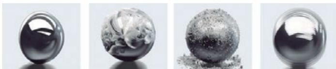
**Figura 7.** Principais causas de falhas prematuras nos rolamentos (mau ajuste, má lubrificação, contaminação e fadiga, respetivamente da esquerda para a direita).
