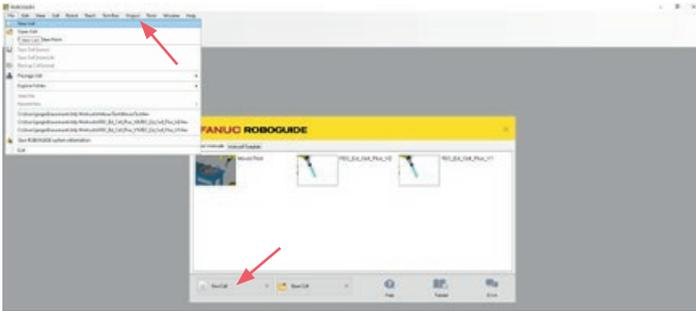
2. Criação de um novo *robot* com as configurações do último *robot* criado. Este método permite que sejam carregadas as configurações de uma simulação anterior.
