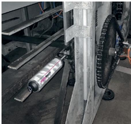
Figura 1. Lubrificação de corrente com simalube 250 ml e escova plana.
