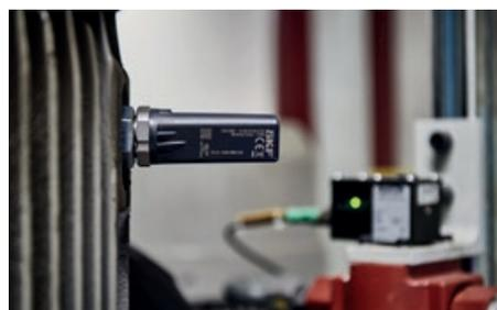
Em 2020 a SKF lançou no mercado um sensor *wireless* de temperatura e vibração compacto e económico para monitorizar o estado de condição de equipamentos rotativos industriais. Projetado como uma solução de desempenho de equipamentos rotativos, o sensor SKF Enlight Collect IMx-1 permite que as empresas reduzam os custos com paragens não programadas e de manutenção.
