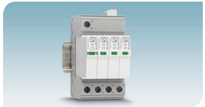
Figura 3 Descarregador do Tipo 2: o VAL-SEC-T2-3S-350-FM da Phoenix Contact é adequado a sistemas de alimentação de 230/400 V AC com ligação à terra local.
