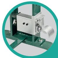
Pedal de aproximação rápido a ar comprimido
