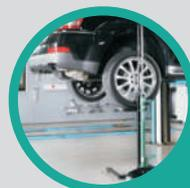
Solução ergonómica para uma fácil desmontagem, manuseamento e montagem de rodas em alumínio com pneus de baixo perfil, até 24"
