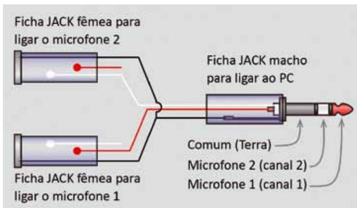
Figura 4 - Esquema das ligações entre os cabos.
