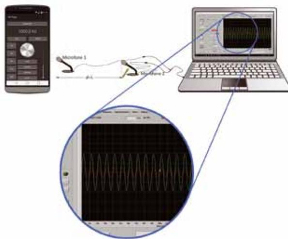
Figura 10 - Determinação direta do comprimento de onda.
