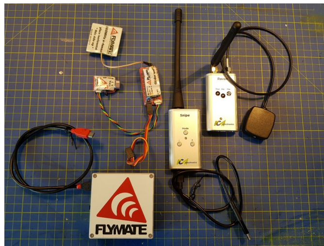
Foto 3: à esquerda o equipamento FlyMate com o receptor em baixo e equipamento embarcado em cima; à direita o Raven (sensores e emissor embarcado) e Snipe (receptor no solo), note-se o tamanho da antena vertical de emissão do Raven.
