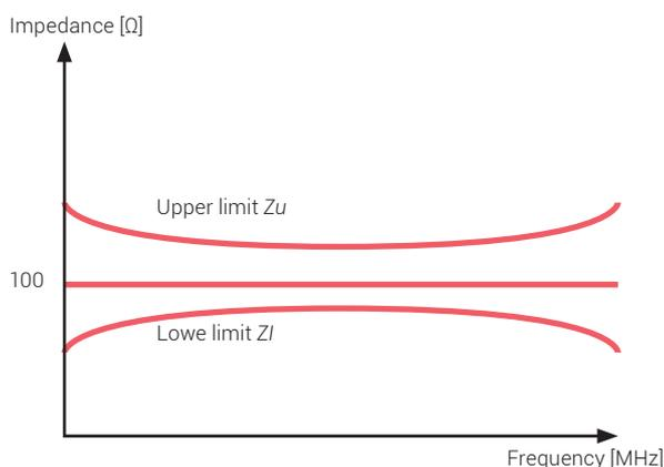
Figura 3. Template da impedância – IEC 61156-5.
